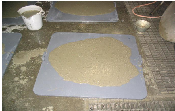
Figure : Mesure de l'affaissement sur table
