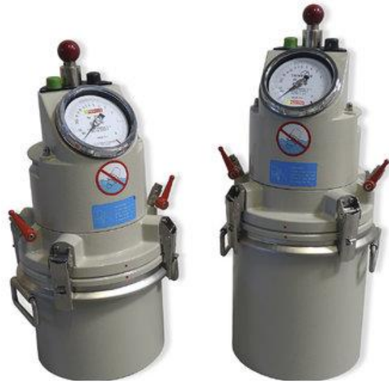
Figure 5.. Manomètre gradué directement en % d'air occlus
