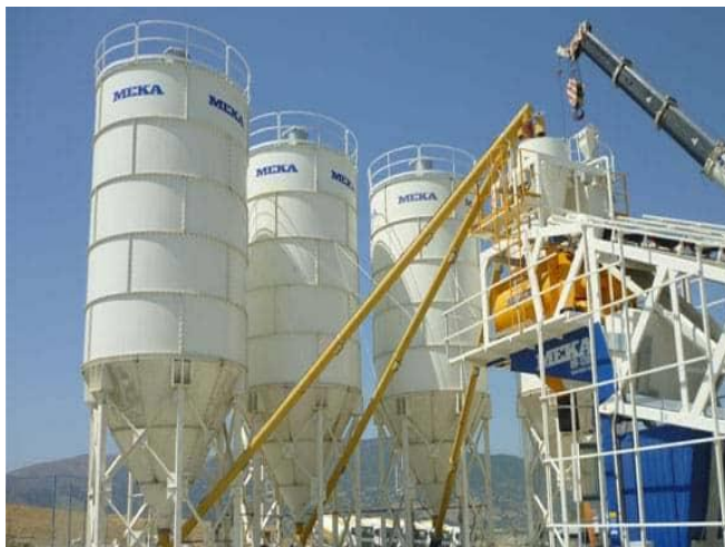
Figure 2. Stockage de ciment : Silos pour stocker le ciment
