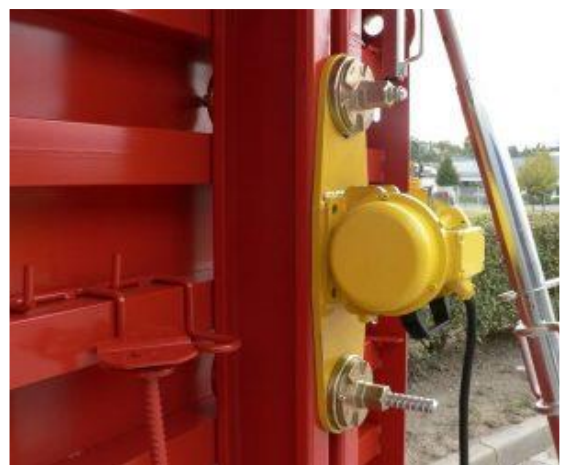
Figure 11. Vibreur béton externe monté sur un coffrage métallique (banche).
