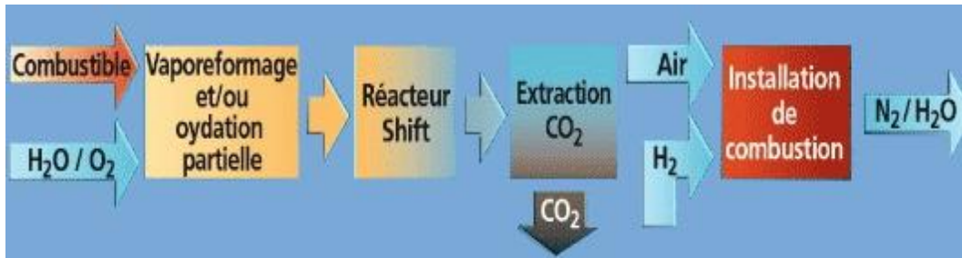
Figure II.3 : Le vaporeformage du gaz naturel
