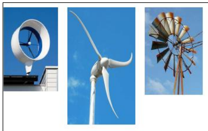
Figure 2.b: Les aérogénérateurs à axe horizontal.
