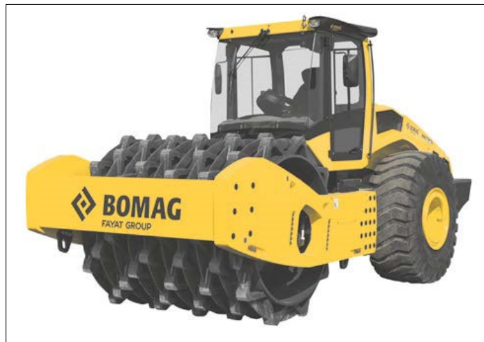
- Un compacteur vibrant à pieds dameurs -
