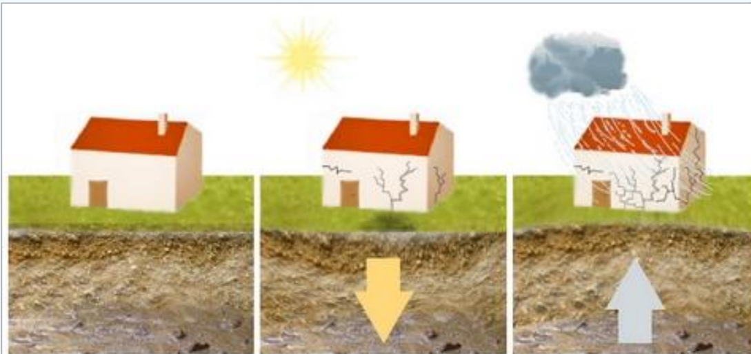
Retrait - Gonflement du sol de fondation
