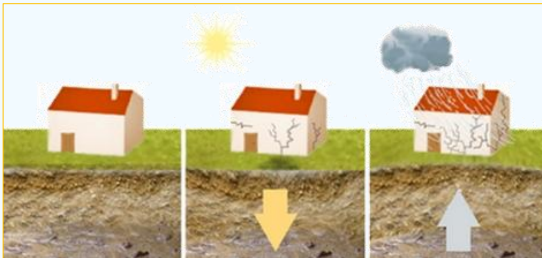
Retrait - Gonflement du sol de fondation
