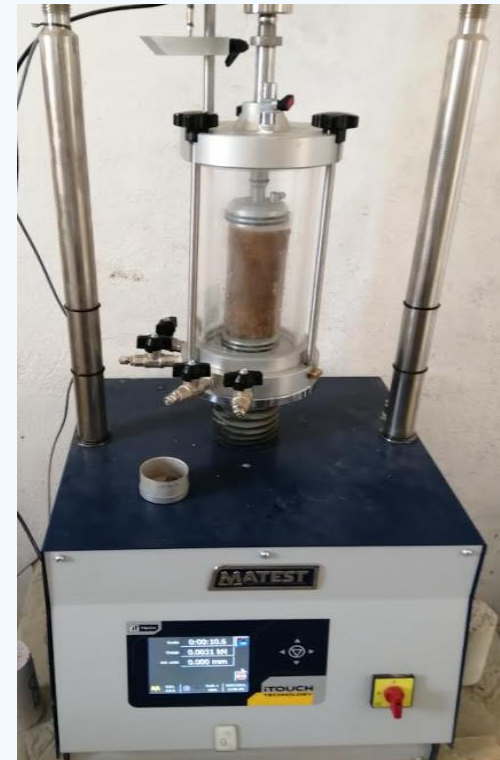
Essai de compression simple sur sol
