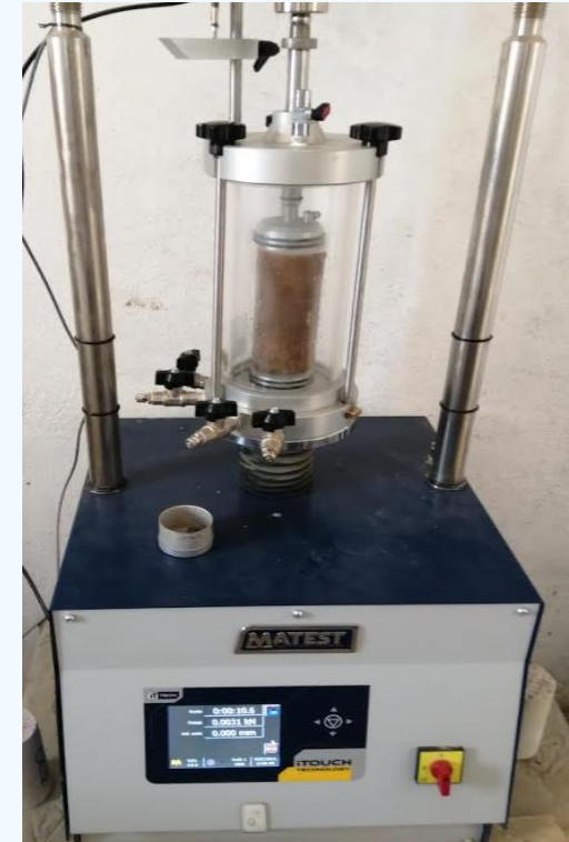
Essai de compression simple sur sol
