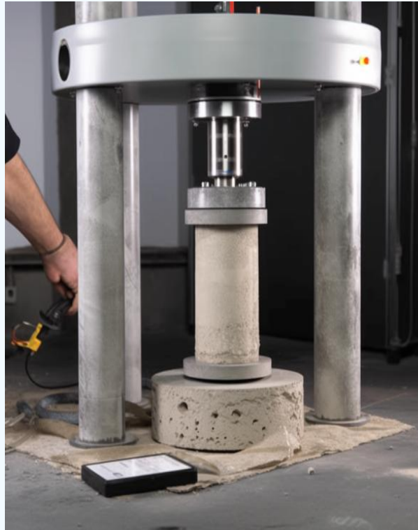
Essai de compression simple sur béton
