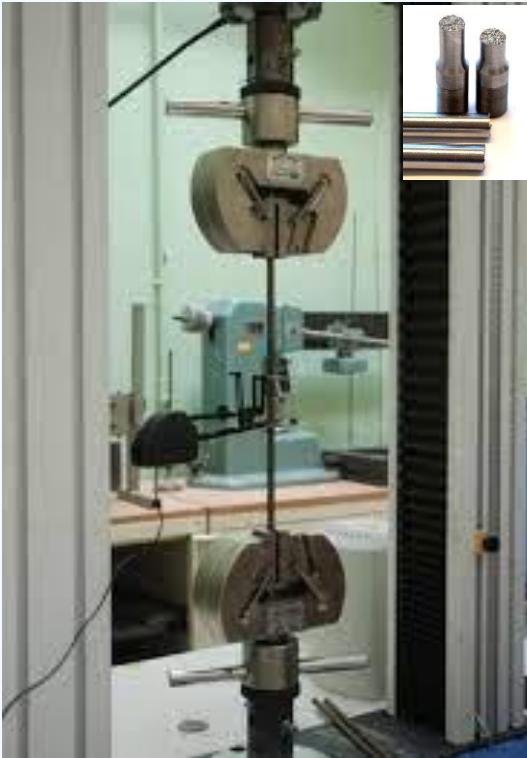
Essai de traction simple sur acier
