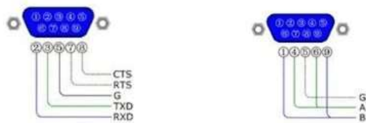
Figure 2. Connecteur RS-485 VS RS-232
