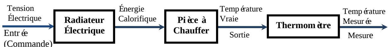
Figure 1.11 Contrôle de la température d'une pièce par un thermomètre
