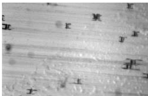
Fig. V. 4 : Rupture de fibres de verre dans un composite à matrice poly-époxyde en traction longitudinale (Diamètre des fibres 20µm)
