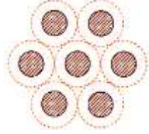
Fig. IV. 8. Arrangement hexagonal de fibres de mêmes diamètres.
