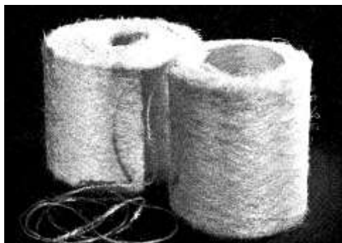
Fig. II. 8: Stratifil bouclé : présentation commerciale
