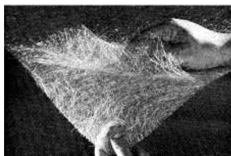
Fig. II. 13 : Vue de détail d'un mat à fils continus
