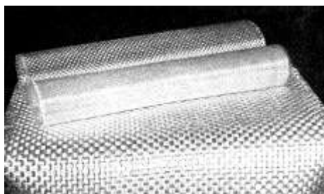
Fig. II. 14 : Exemples de trois tissus, armure toile, réalisés à partir de stratifils de masses linéiques
