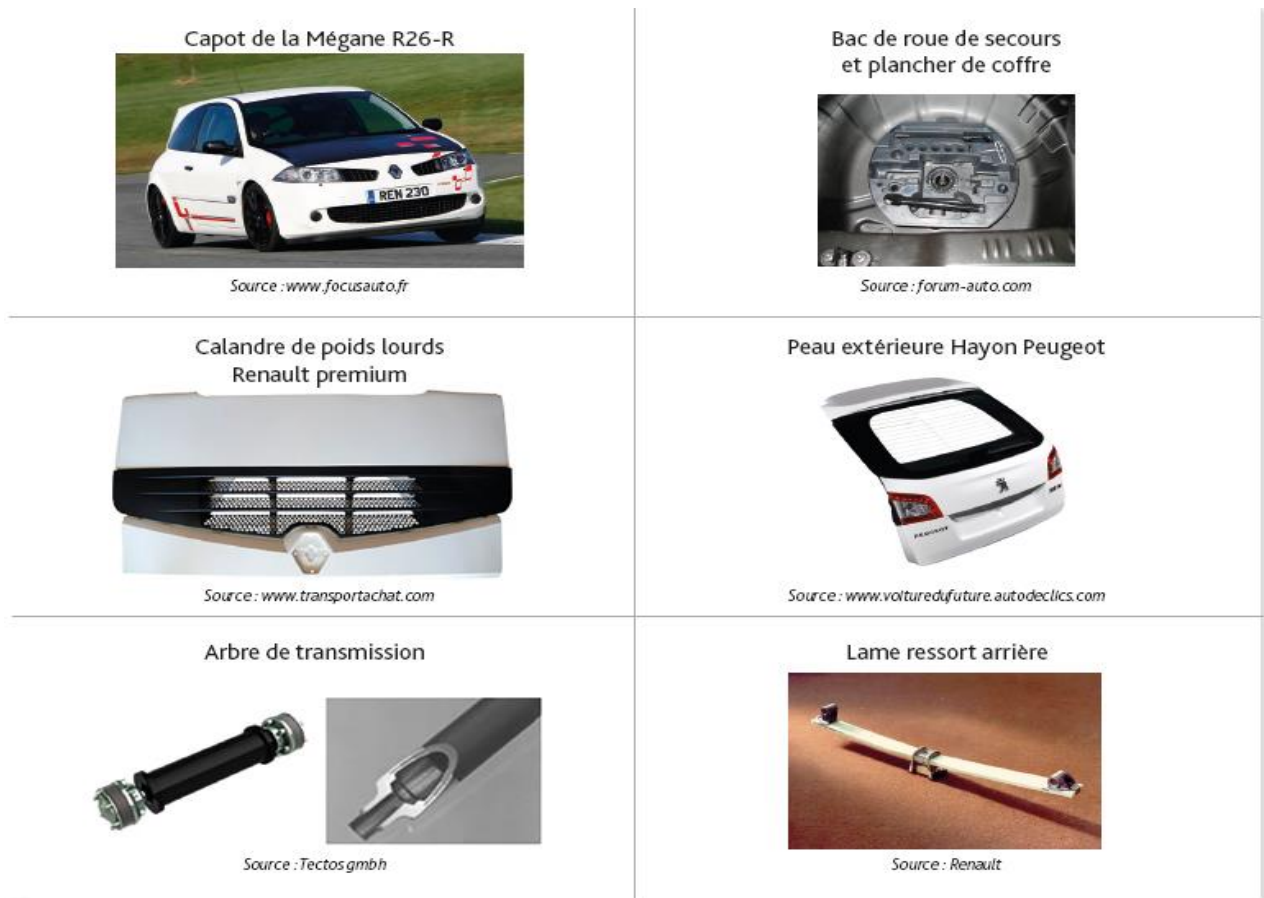
Figure1– Exemples de pièces automobiles en matériaux composites [8]
