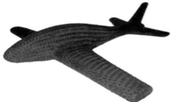
Figure 3: Un modèle réduit d'avion en tissu de carbone 3D, réalisé pour tester un procédé de fabrication de préformes [9] (image de l'Université nationale du design et des technologies de Moscou).
