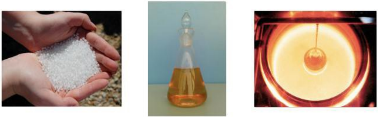
Figure 4 : Quelques matrices avant mise en forme : (a) granulés thermoplastiques, (b) résine thermodurcissable, (c) silicium fondu, utilisé pour former une matrice de carbure de silicium [9].
