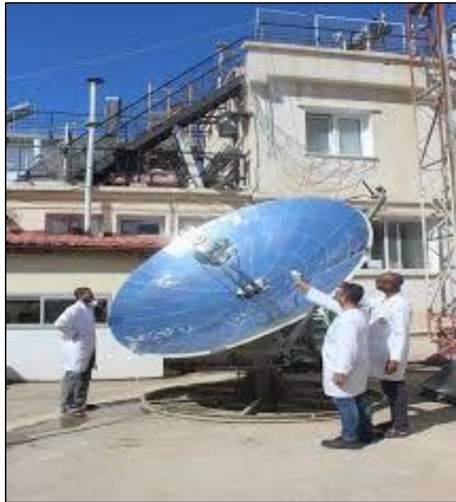
Figure 2 : Concentrateur parabololoïde de révolution (Dish System).
