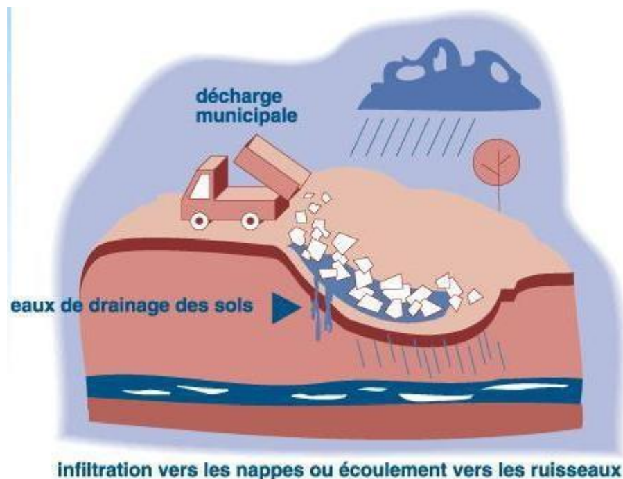
Figure 17 : Infiltration des lixiviats vers les nappes phréatiques( KIRAT AMINA , 2015)
