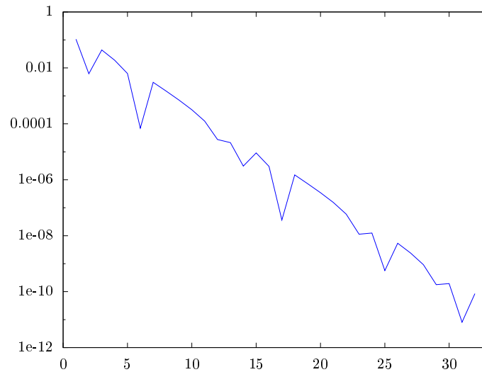
FIGURE 5.2 – Historique de la convergence, c’est-à-dire le tracé de l’erreur |x^{(k)} - \xi| en fonction k , de la méthode de dichotomie pour l’approximation de la racine \xi = 0,9061798459\dots du polynôme de Legendre 5 de degré 5, P_5(x) = \frac{x}{8}(63x^4 - 70x^2 + 15) , dont les racines se situent dans l’intervalle ] -1, 1[ . On a choisi les bornes a = 0,6 et b = 1 pour l’intervalle d’encadrement initial et une précision de 10^{-10} pour le test d’arrêt, qui est atteinte après 31 itérations (à comparer à la valeur 30,89735\dots de l’estimation (5.7). On observe que l’erreur a un comportement oscillant, mais diminue néanmoins en moyenne.
