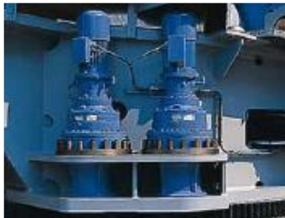
Figure 3.6 : Le système d'orientation.
