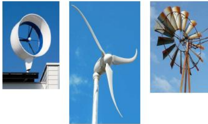
Figure 3.2 : Les aérogénérateurs à axe horizontal.
