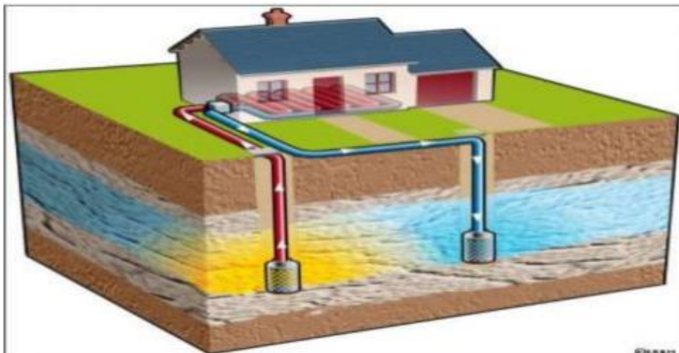
Figure VI.4 : Géothermie à très basse énergie.
