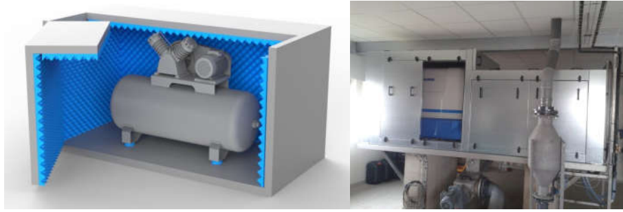
Figure IV.3 : Capotage d'une source de bruit
