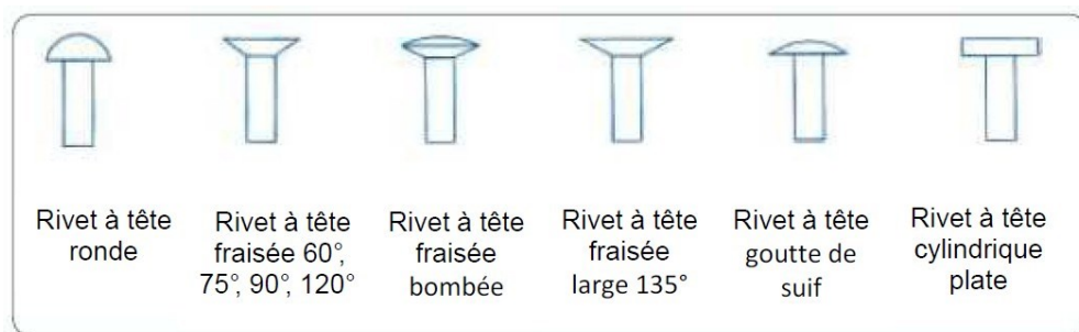
Figure 1: Formes de tête de rivet.
