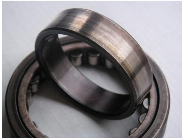
Figure VI.3 : Début de grippage d'un roulement.
