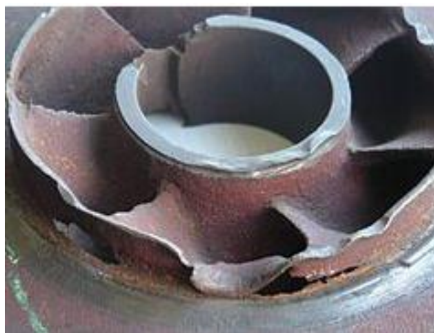
Figure VI.12 : Cavitation d'une roue de pompe.
