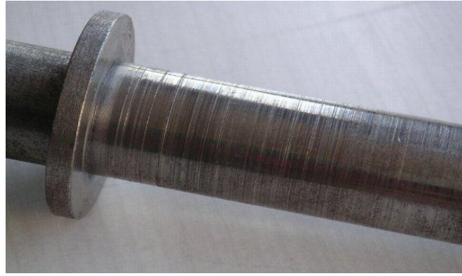
Figure VI.8: Stries d'abrasion sur un tourillon.
