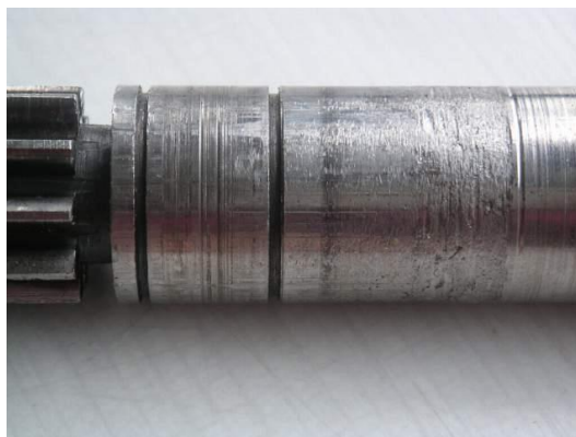
Figure VI.2 : Tourillon avec diverses traces d'usure.
