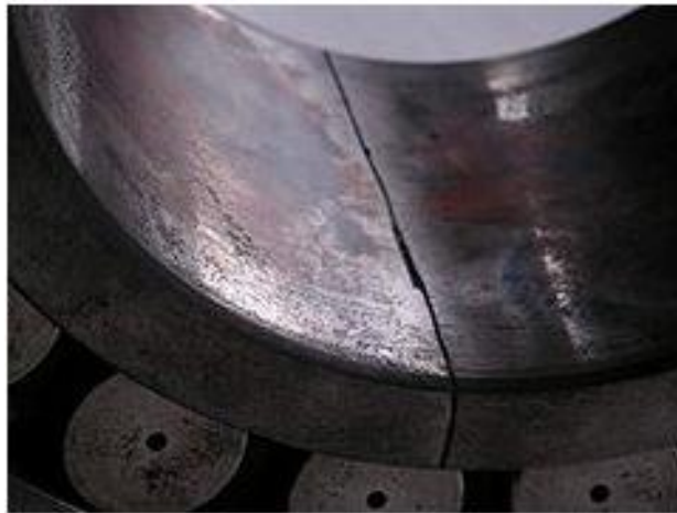
Figure VI.10 : Bague de roulement usée par corrosion.
