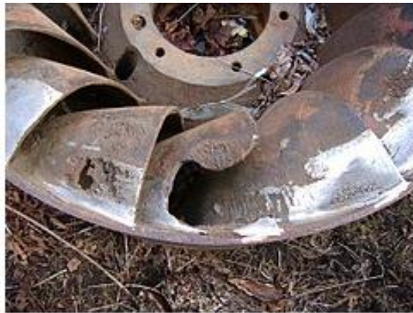
Figure VI.13 : Usure par cavitation d'une turbine.
