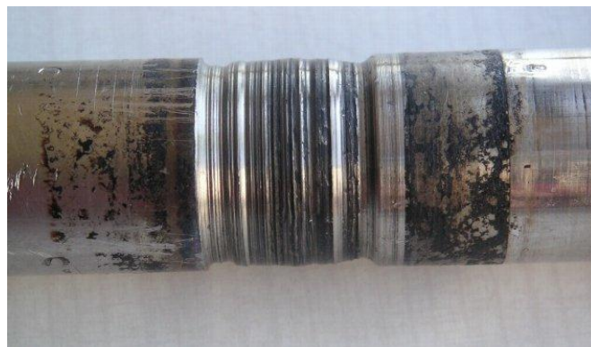
Figure VI.9 : Usure abrasive à trois corps.
