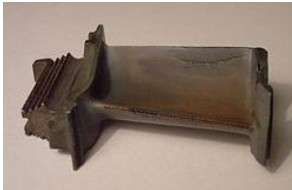
Figure IV.16: Aube de turbine à gaz usée par érosion
