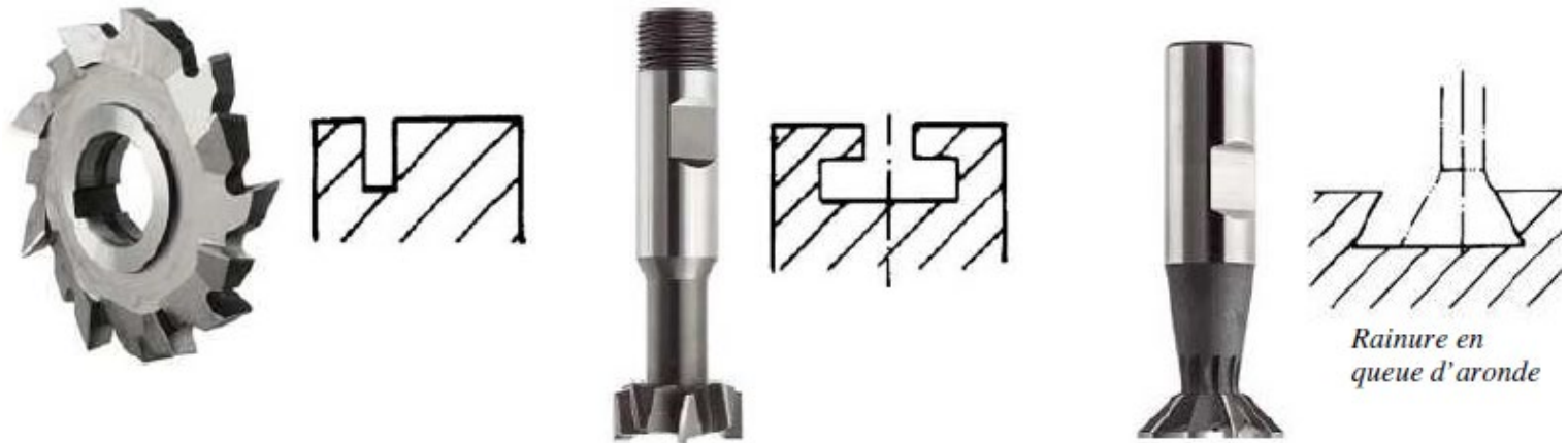
Fig. 6 Opération de rainurage
