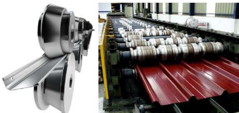
Fig. 6 Procédé de profilage
