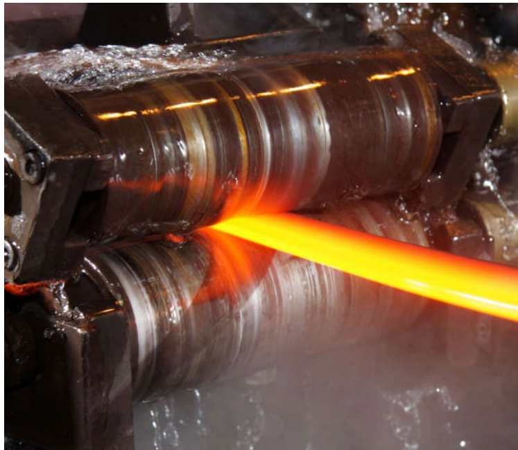
Fig.2 Laminage à chaud
