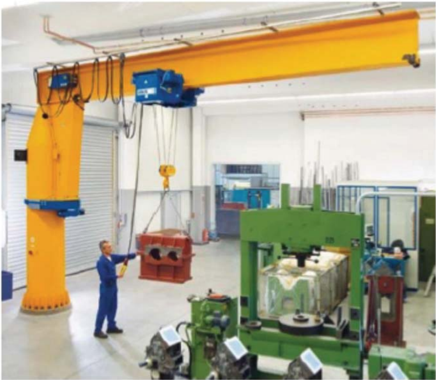
Figure. 5.1. Système manutention à réducteur de vitesse
